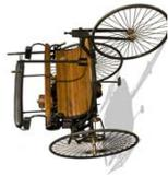
Franzose M. Gustave Trouvé wird als wegweisender Pionier der Elektromobilität bezeichnet. Dieser präsentierte auf der internationalen Elektrizitätsausstellung in Paris ein bis zu 12 km/h schnelles Dreirad. Erstes Fahrzeug mit Eletromotor und wiederaufladbarer Batterie.
